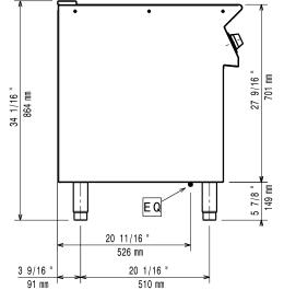
Electrical inlet (power) EQ Equipotential screw
